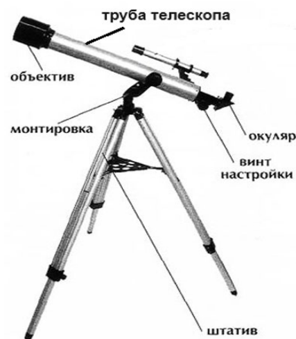
Устройство телескопа
